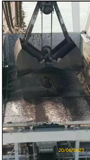
รูปที่ 2-1 ระบบฉีดน้ำบริเวณ Ship Unloading Hopper
